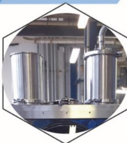
**Sistema di filtrazione:** la camera di lavoro è provvista di un apposito sistema di filtrazione in base al grado di contenimento che si desidera ottenere (filtri in poliestere o con filtri HEPA).
