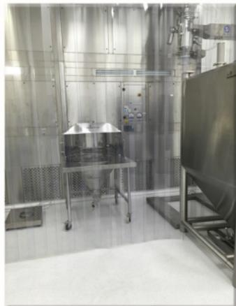
Sistema di svuotamento sacchi manuale collegato ad un sistema di trasferimento polvere
